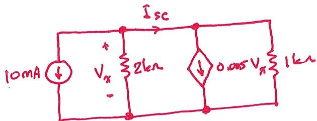
$$10\text{mA} + \frac{V_x}{2k\Omega} + 0.005V_x + \frac{V_x}{1k\Omega} = 0$$
